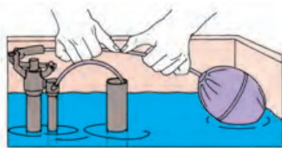
شکل ۲۷-۱۲- طرز تنظیم شیرهای شناور
