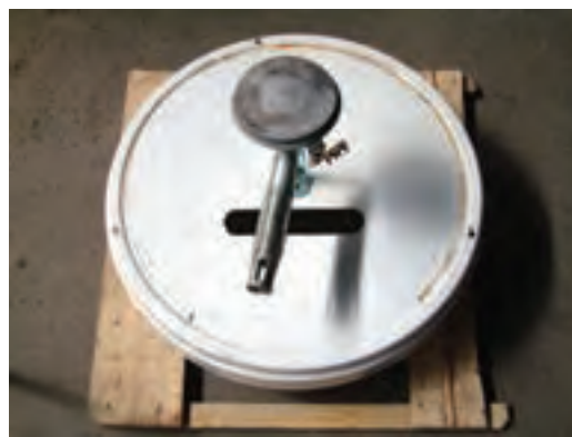
شکل ۴-۱۲- اجاق (کوره) آب گرم کن سرویس (تمیز) شده
