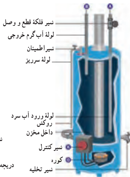
الف) برش آب گرم کن مخزنی گازسوز
