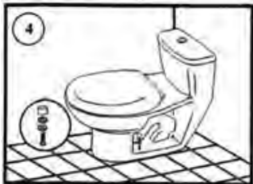
شکل ۴-۱۰-ت - محکم کردن پیچ های استقرار
