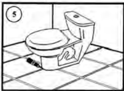
شکل ۴-۱۰-ث - آب بندی درز های محل استقرار
