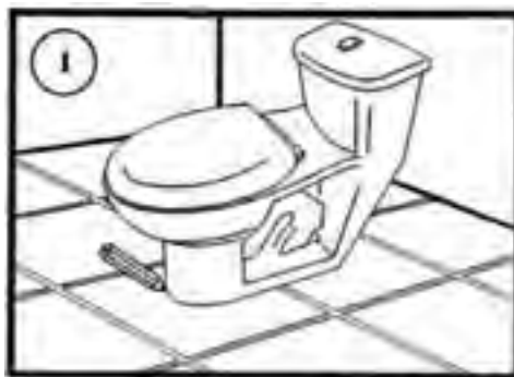
شکل ۴-۱۰-الف - مشخص کردن محل استقرار
