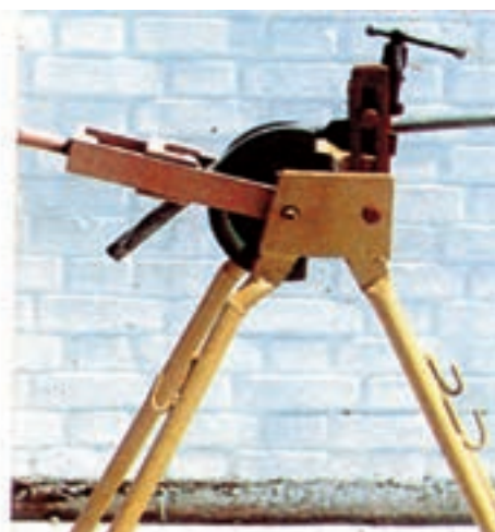
شکل ۱۲-۶ - مراحل مختلف خم کردن لوله فولادی
