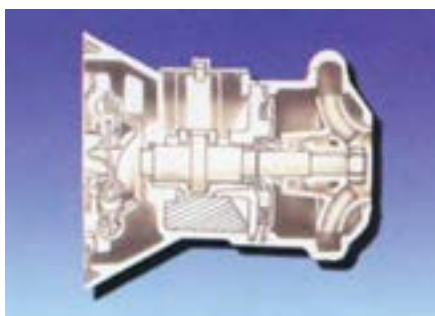
شکل ۴۶-۵- سیستم روغن کاری پمپ خطی
