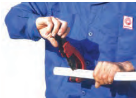
شکل ۳-۴- لوله بر و نحوه کار با آن
