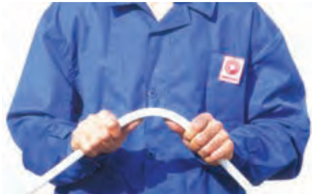
شکل ۸-۴- نحوه خم کردن لوله با دست و فنر
