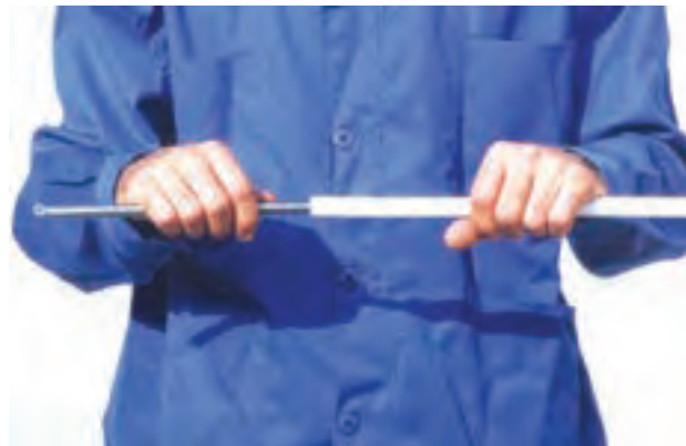
شکل ۸-۴- نحوه خم کردن لوله با دست و فنر
