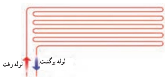
شکل ۴-۲۰- آرایش مارپیچی (کویلی) کف گرمایی
