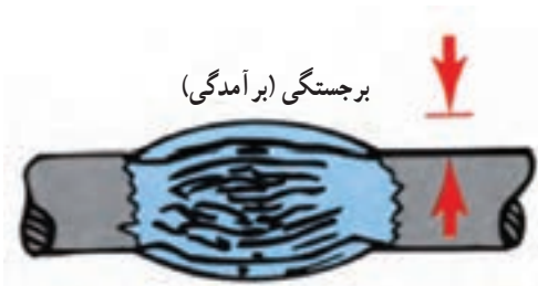
شکل ۱۳-۶ - جوش واژگونه سربه سر
