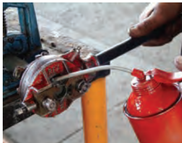
شکل ۱-۳۴ - ریختن روغن برای روانکاری و خنک‌کاری
