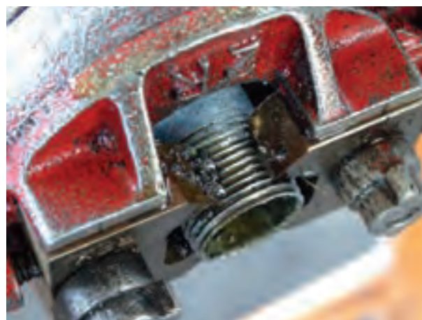
شکل ۱-۳۵ - پایان حدیده‌کاری با عبور دو دندان از سر لوله
