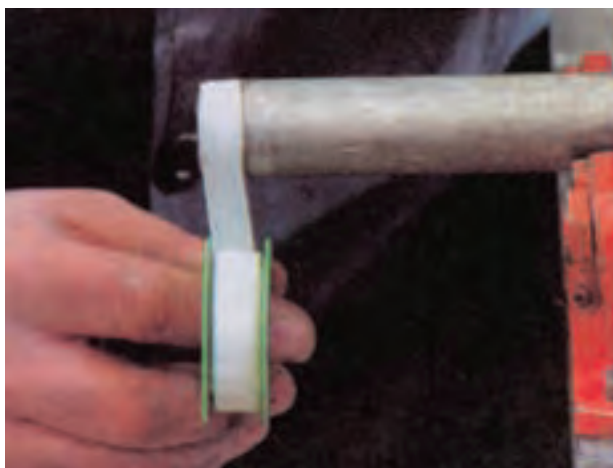
شکل ۵۳-۱- پیچیدن نوار تفلون به سر لوله
