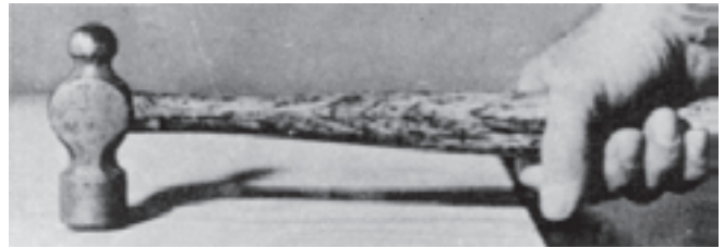
شکل ۱-۲۶-الف - چکش باید به طور کامل با سطح جسم تماس بگیرد.
