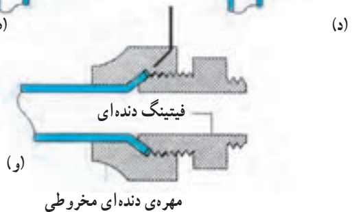
شکل ۱۷-۱-۱۷ - طریقه‌ی لاله کردن لوله‌ی مسی
