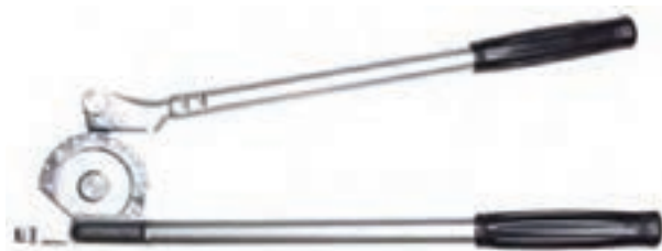
شکل ۱-۳۴- اجزای لوله خم‌کن اهرمی
