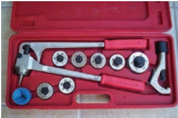
شکل ۲۵-۱- جعبه‌ی گشادکن اهرمی لوله‌ی مسی با فک‌های مختلف
