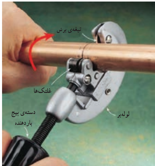
شکل ۱۱-۱- طریقه‌ی بریدن لوله‌ی مسی با لوله‌بر
