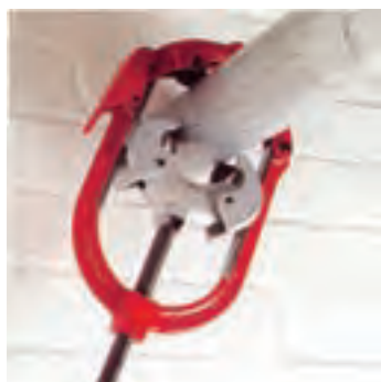
لوله‌بر چهار تیغه در حال کار
