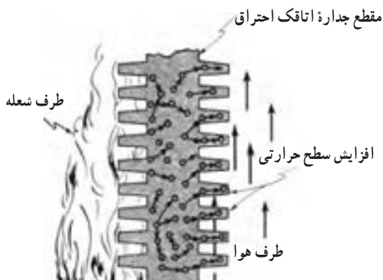
شکل ۱-۷ انتقال گرما به طریق هدایت
