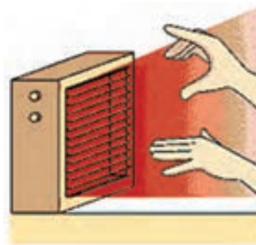
شکل ۱۰-۱ انتقال گرما به روش تابش
