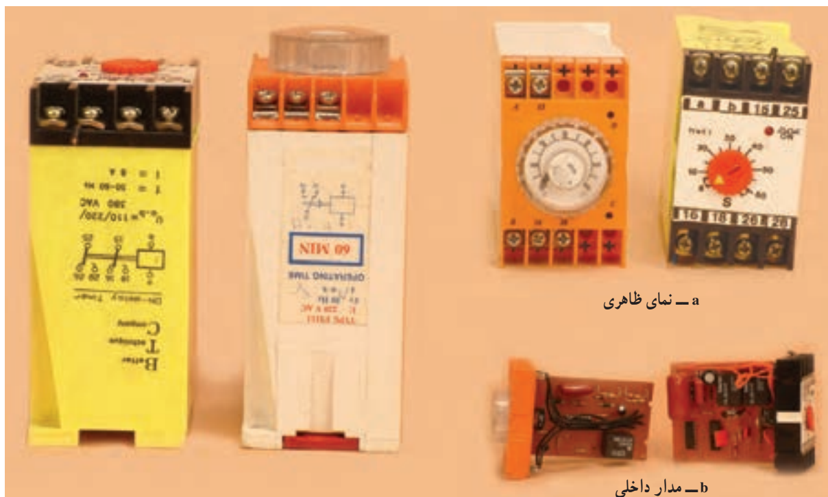
شکل ۸-۲۳- نمای ظاهری و مدار داخلی تایمر الکترونیکی
