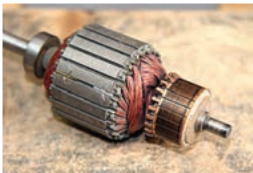
شکل ۳-۷ (الف) آرمیچر بدون سیم پیچی (ب) آرمیچر سیم پیچی شده (ب)
