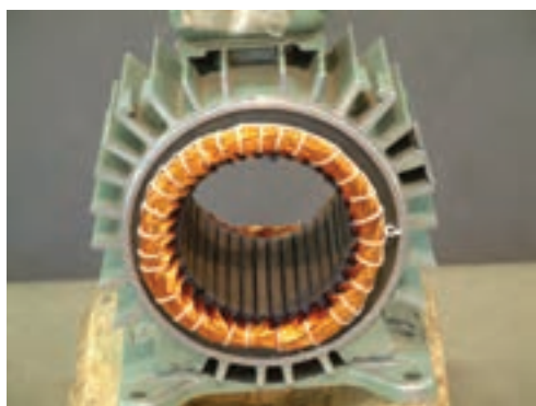
شکل ۱۱-۷- استاتور یک موتور AC
