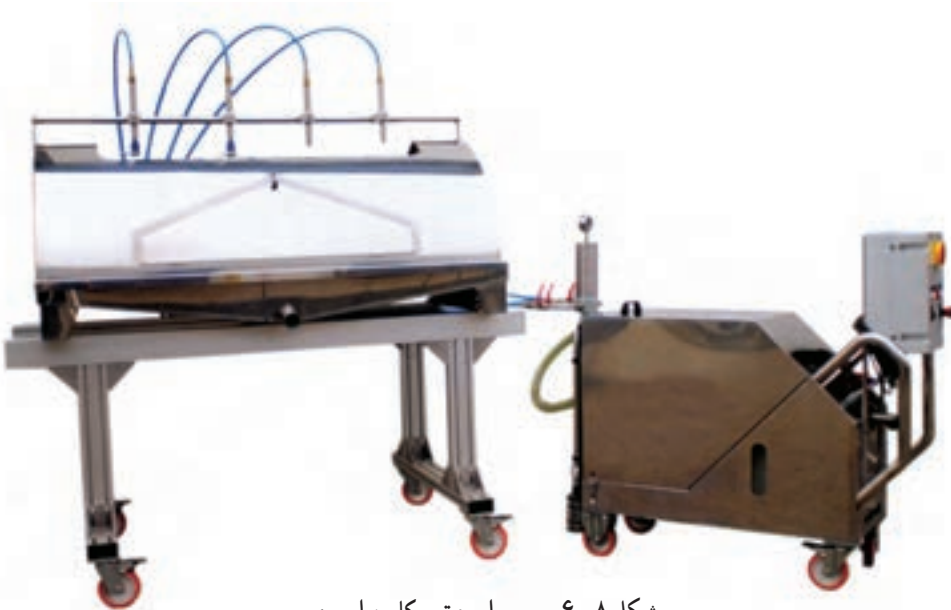
شکل ۸-۶- پمپ ایرجت و کابین اسپری
