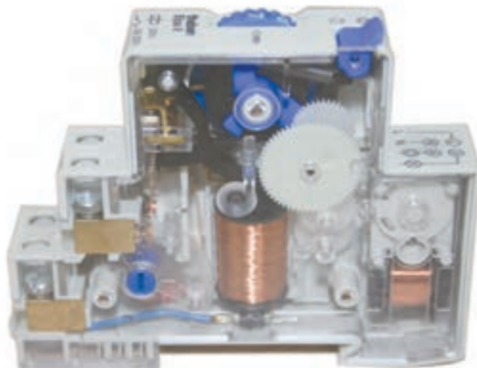
شکل ۵-۲۳- شمایی از یک رله‌ی زمانی
