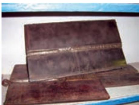
شکل ۱۱-۱۲- نمونه در جوش شده شیاری
