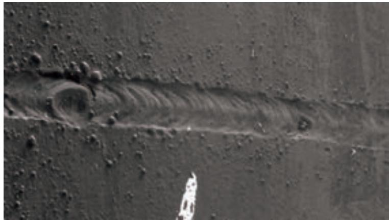
شکل ۱۶-۲۰- عدم پرشدگی شیار
