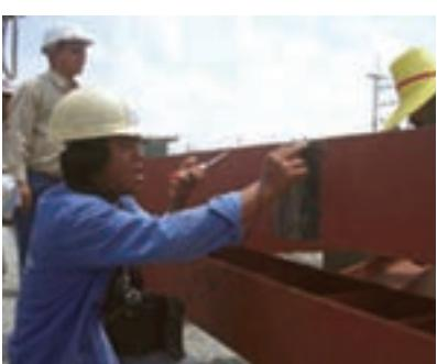
شکل ۱۲-۲۸- دستگاه تست فراصوت
