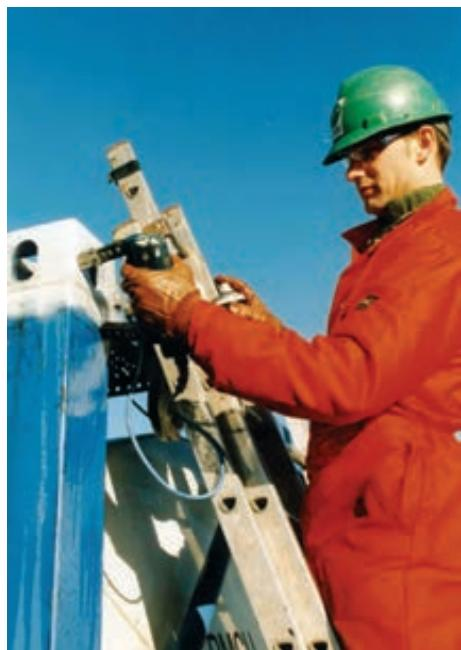
روش ذرات مغناطیسی به این صورت است که براده‌های آهن را در اطراف جوش ریخته و در اثر عبور جریان الکتریکی یک میدان مغناطیسی در اطراف جوش ایجاد کرده تا براده‌های آهن در امتداد این میدان قرار گیرند. در محل عیوب، پیوستگی و نظم براده‌های آهن بهم خورده که توسط بازررس مربوطه قابل تفسیر می‌باشد.
