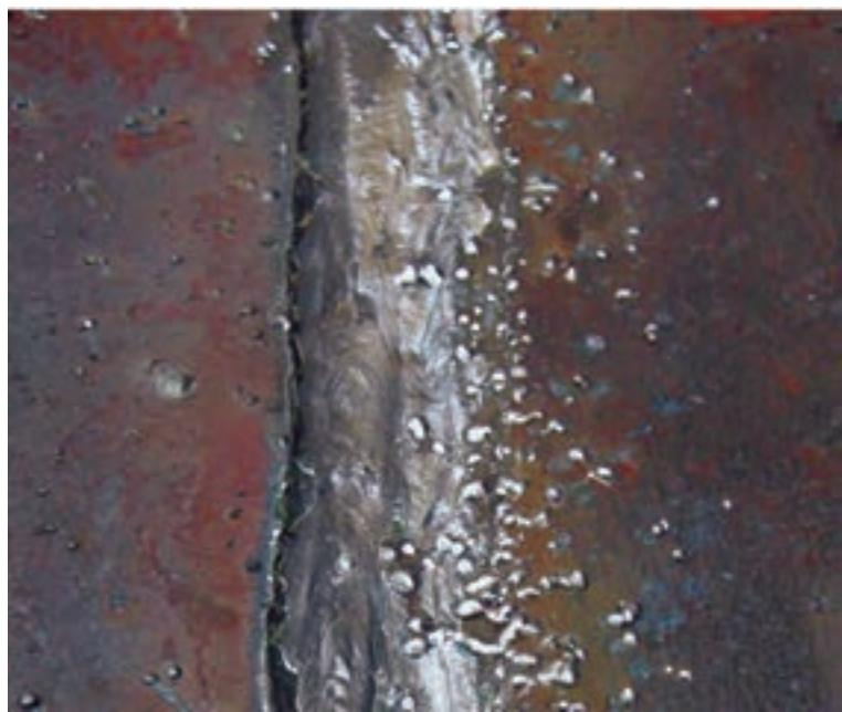
شکل ۱۶-۲۱- نمونه‌ای از پاشش جوش
