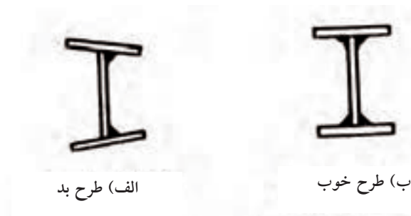
شکل ۱۱-۱۷- تأثیر ممل قرارگیری جوش
