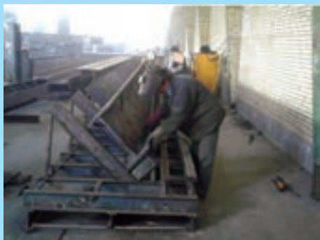
جوش طولی به روش زیرپودی
