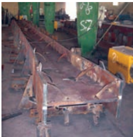
مونتاژ تیورق با تغییر مقطع در قالب
