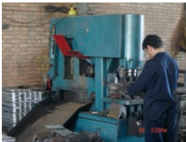
ب- دستگاه برش پروفیل‌های سبک (نبشی و ناودانی) و پانچ
