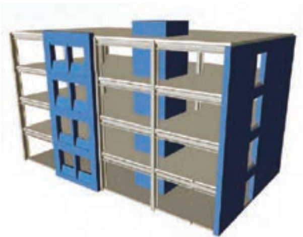
شکل ۹-۳- دیوار برشی بتنی در سازه فولادی
