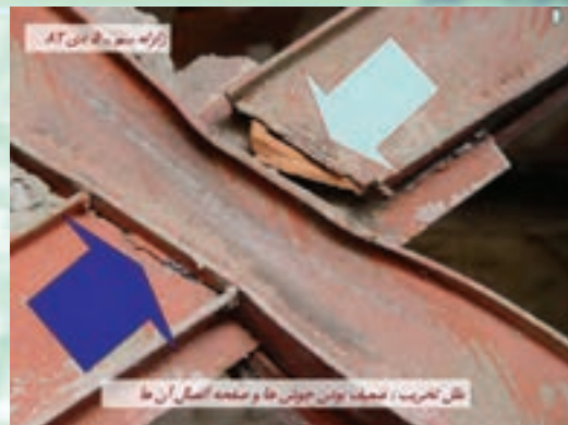
علل تخریب: ضعف بودن جوش ها و صفحه اتصال آن ها
