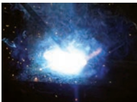
قوس الکتریکی در جوشکاری با الکترود روکش‌دار
