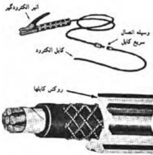
شکل ۷-۲۷ - مقطع کابل جوشکاری قوسی
