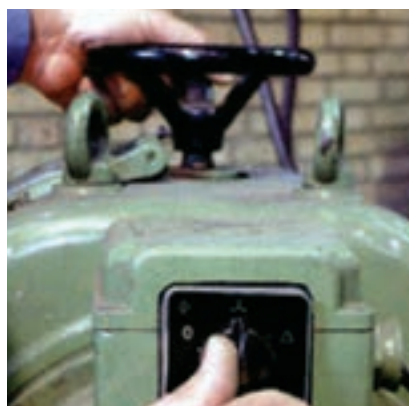
شکل ۷-۲۱- قرار دادن کلید دینام جوشکاری
