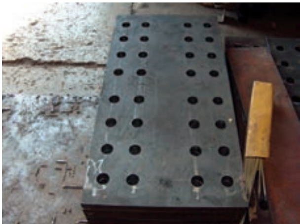
نمونه‌ای از ورق اتصال سوراخ‌کاری شده
