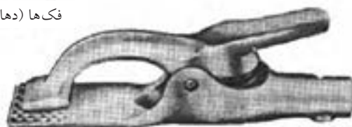
شکل ۷-۳۲- گیره اتصال به قطعه کار
