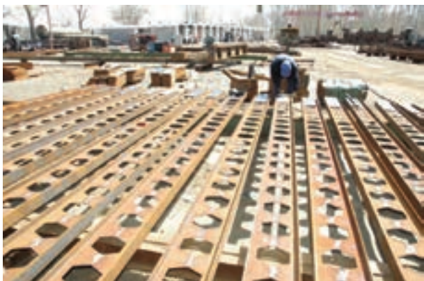
ادامه شکل ۵-۲۲- جوشکاری محل اتصال دونیمه
