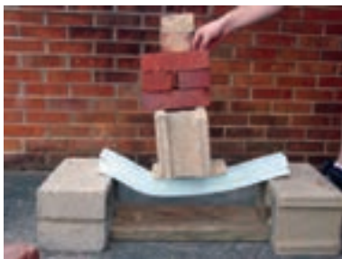
شکل ۵-۵- آزمایش فمش تیر
