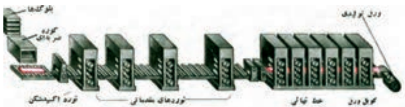
شکل ۱-۱۴- خط تولید نورد ورق
