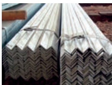
شکل ۱-۱۷- پروفیل‌های نورد شده مورد استفاده در ساختمان
