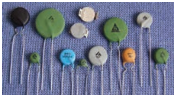
شکل ۳-۱۹ مجموعه‌ای از NTC و PTC به صورت قطعات جدا از هم
