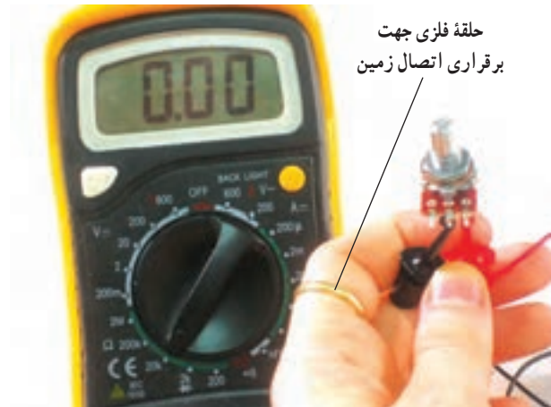
شکل ۳-۸- اتصال مقاومت متغیر به مولتی‌متر دیجیتالی
