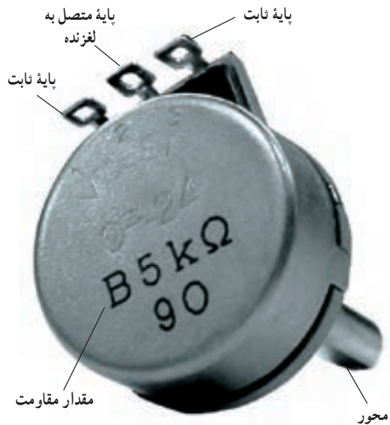
شکل ۳-۳ مقدار نوشته شده روی مقاومت
