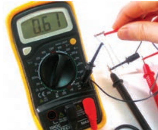
شکل ۳-۲۲- اندازه گیری مقاومت LDR
