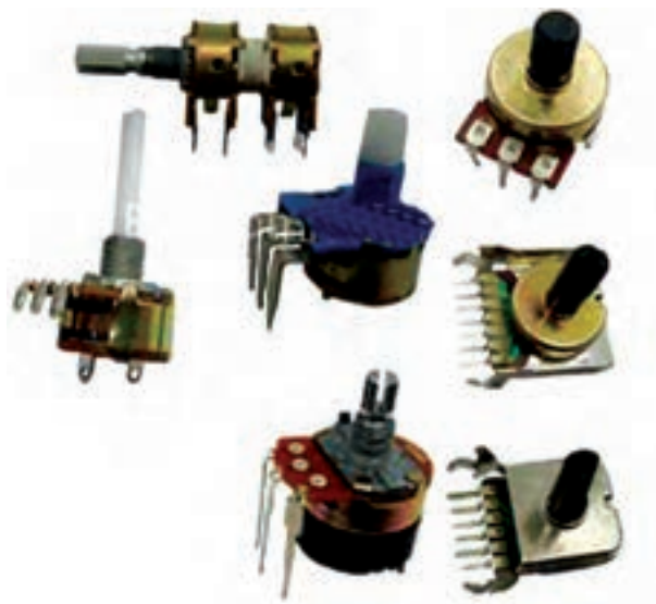
شکل ۱-۵۴- چند نمونه مقاومت معمولی با محور دورانی
