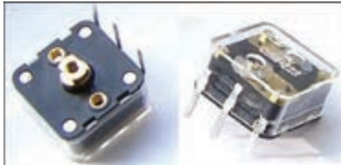
شکل ۱-۷۲- چند نمونه خازن متغیر
