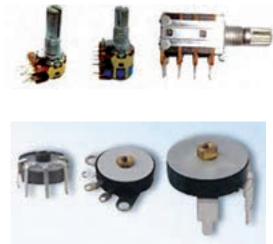
شکل ۱-۵۴- چند نمونه مقاومت معمولی با محور دورانی
