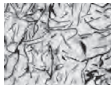
شکل ۲-۴۹ چدن خاکستری با گرافیت ورقه‌ای
