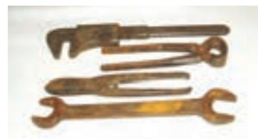
شکل ۱-۴۶ آثار خوردگی بر سطح ابزار
