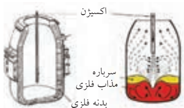
شکل ۲-۸ کوره L-D یکی از روش‌های تولید فولاد.
