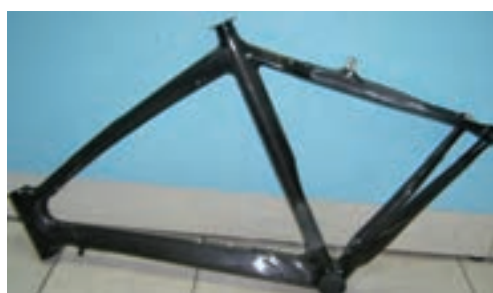
شکل ۱-۱۸ بدنه یک دوچرخه از الیاف کربن
