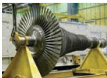
شکل ۲-۳۵ کاربرد فولادهای نسوز در تولید توربین‌های گازی
