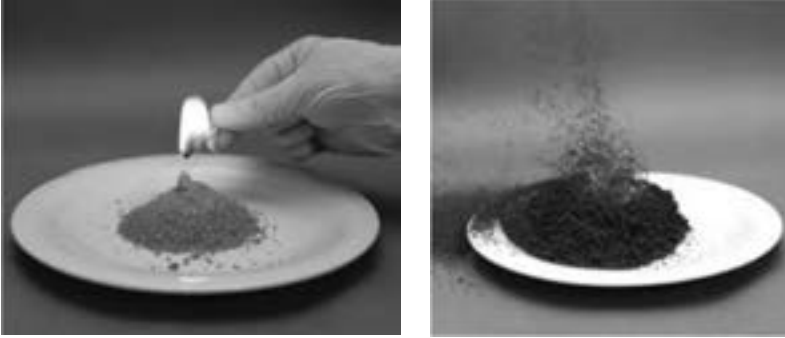
شکل ۲-۵- آمونیوم دی کرومات در اثر گرما تجزیه می‌شود و ضمن آزاد کردن نور و گرما، گاز تولید می‌کند. (گاز نیتروژن + بخار آب + کروم (III) اکسید → آمونیوم دی کرومات)
