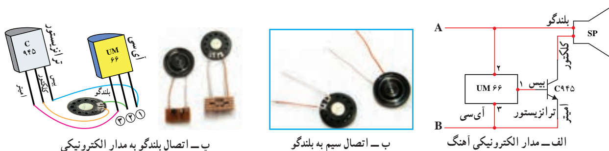
شکل ۲-۲۶ - مدار الکترونیکی جعبه آهنگ
