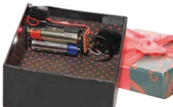
شکل ۲۸-۲ - جانیابی مدار پروژه و کلید
