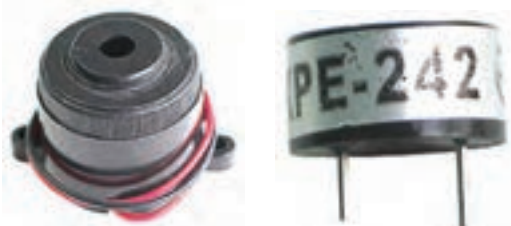
شکل ۹-۲۷ - شکل ظاهری صفحه حساس پیزوالکتریک
