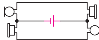
شکل ۹-۳۱ مدار مکالمه دو طرفه با یک باتری
