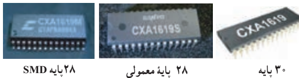
شکل ۶-۸ - تصویر ظاهری دو نمونه IC گیرنده رادیویی AM/FM
