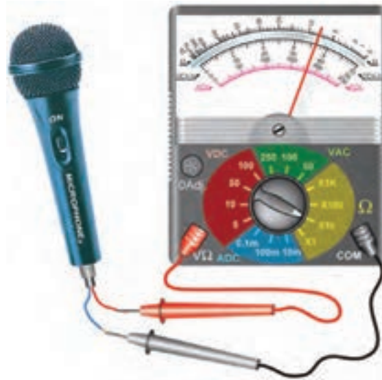
شکل ۵-۱۴ - اندازه گیری مقاومت اهمی میکروفون دینامیکی با استفاده از اهم متر
