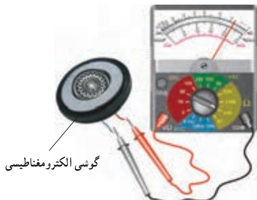
شکل ۵-۱۲- نحوه اتصال گوشی الکترومغناطیسی به اهم متر
