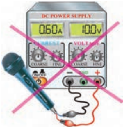
شکل ۵-۱۰ ولتاژ DC را به میکروفون مستقیماً وصل نکنید.
