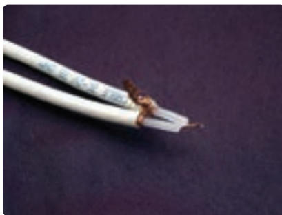
شکل ۴-۱۶- کابل نباید دو تکه باشد.
