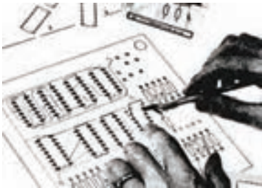
شکل ۲۹-۴- نحوه چسباندن لتراست مربوط به پایه قطعات
