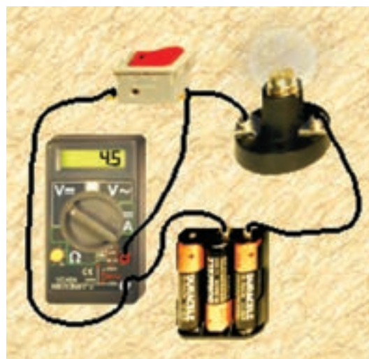
شکل ۵-۱-۵-۱-۵-۱ ولتاژ دوسر کلید در دو حالت روشن و خاموش
