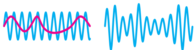
شکل ۳-۱۳ - مقایسه ترکیب پیام و حامل در مدولاسیون AM با سیگنال غیر سینوسی
