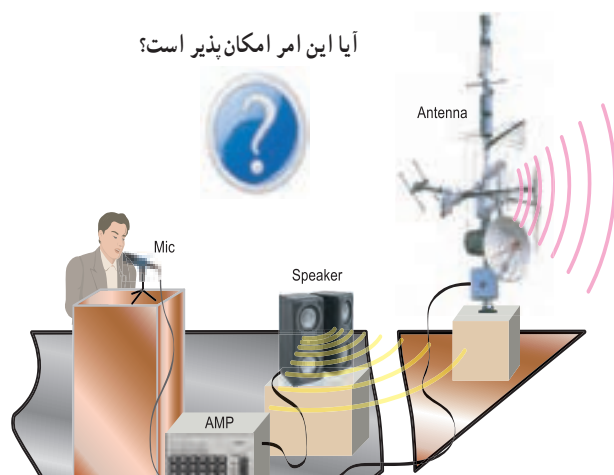
شکل ۷-۳- تبدیل امواج صوتی به امواج الکترومغناطیسی
