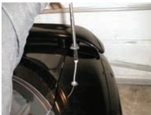
شکل ۲-۵۸- محل نصب آنتن اتومبیل
