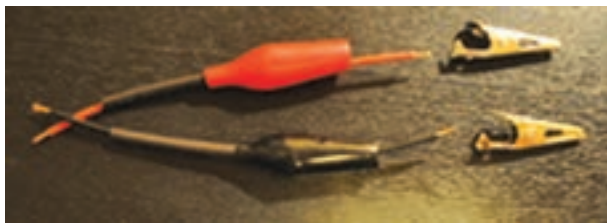
شکل ۱-۹۴- لخت کردن سیم و عبور دادن روکش گیره سوسماری از آن
