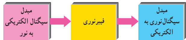
شکل ۲-۸- اساس یک سیستم فیبر نوری
