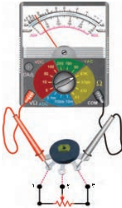
شکل ۱-۳۲- اندازه‌گیری مقدار کل مقاومت ولوم
