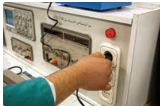
شکل ۱-۲۰- اتصال صحیح دو شاخه
