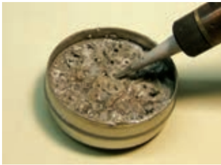
شکل ۱-۳۹- فرو کردن نوک هویه در روغن لحیم
