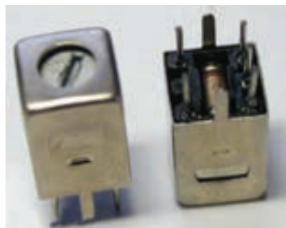
ترانس IF و خازن داخل آن
