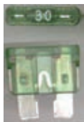
یک نمونه فیوز که در اتومبیل به کار می رود.
