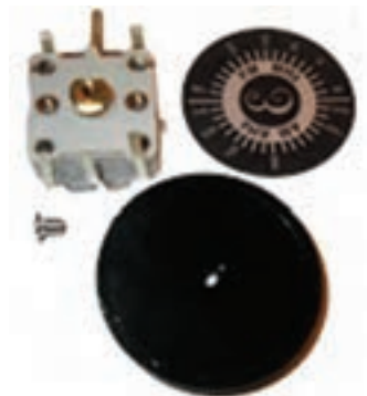
خازن متغیر و اجزای جانبی آن
