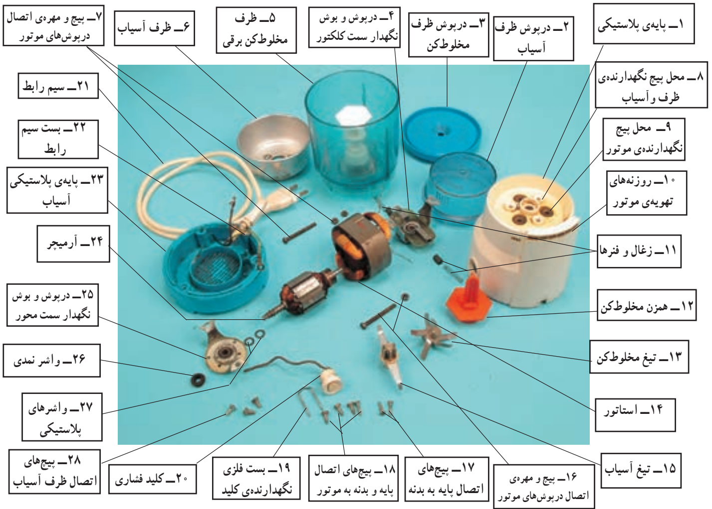
شکل ۴-۳۲- اجزای ساختمانی یک نمونه مخلوط‌کن برقی
