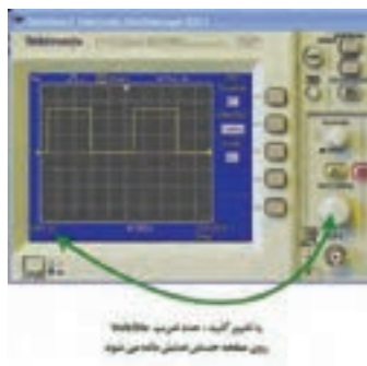
شکل ۴۸-۶ تغییر کلید Volt/Div و نمایش شکل موج
