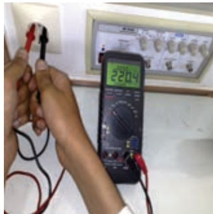
شکل ۳۱-۶- اندازه گیری ولتاژ متناوب برق شهر توسط مولتی متر
