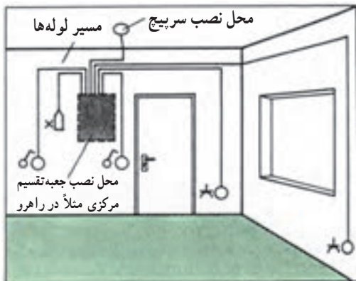
شکل ۶-۷ سیم‌کشی به روش استفاده از جعبه‌ی تقسیم مرکزی
