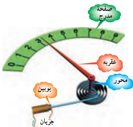
شکل ۳۲-۵- دستگاه اندازه‌گیری با هسته متحرک
