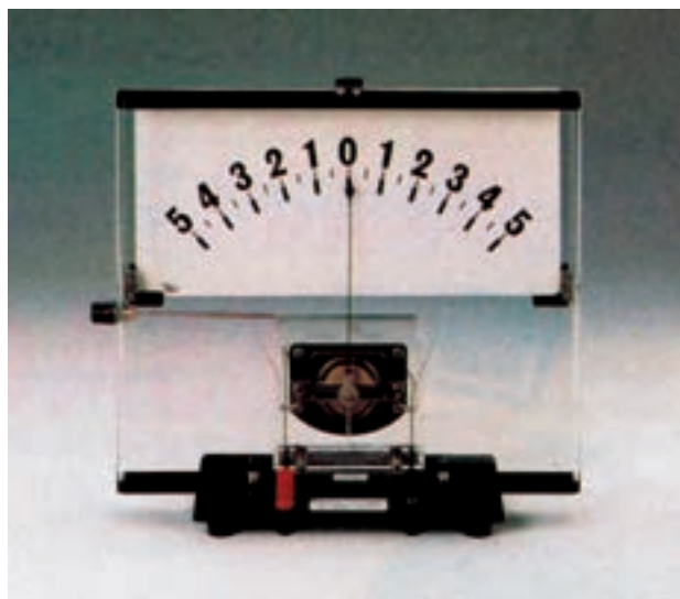
شکل ۱-۵ دو نمونه گالوانومتر «دآرسونوال»
