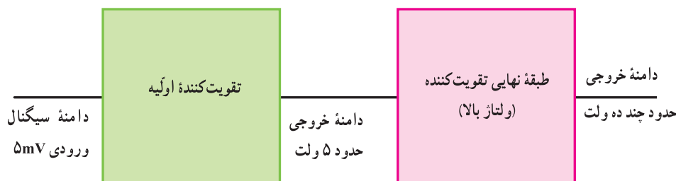
شکل ۲۰-۴ تقویت کننده‌های اسیلوسکوپ
