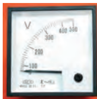
(وسایل اندازه‌گیری آنالوگ) آمپرمتر و ولت‌متر و وات‌متر تابلویی
