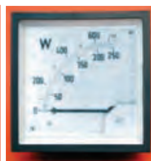
(وسایل اندازه‌گیری آنالوگ) آمپرمتر و ولت‌متر و وات‌متر تابلویی
