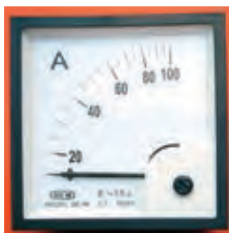
(وسایل اندازه‌گیری آنالوگ) آمپرمتر و ولت‌متر و وات‌متر تابلویی
