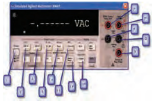
شکل ۱۳۵-۲ معرفی کلیدهای مولتی متر دیجیتالی
