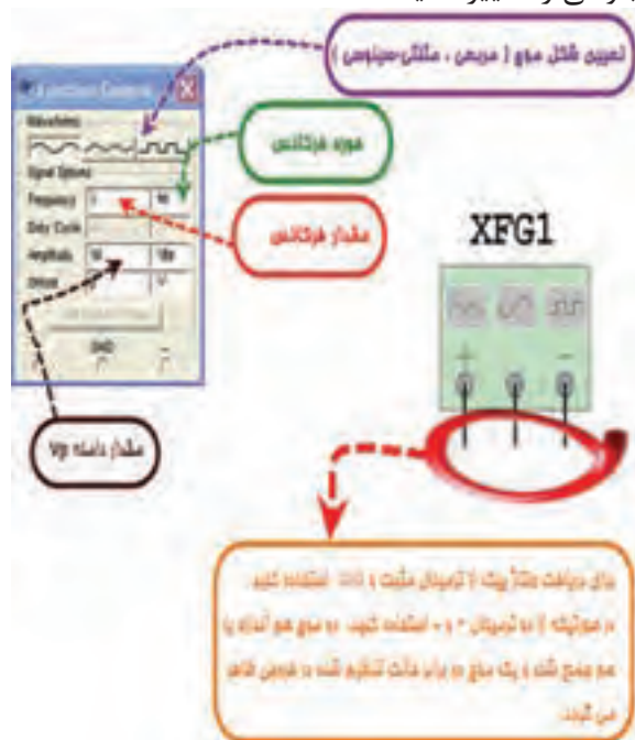
شکل ۸۰-۲ فانکشن‌ژنراتور و صفحه‌ی تنظیم آن
