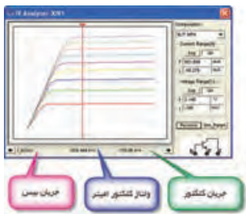
شکل ۱۳۳-۲-ب- مشخص شدن نقطه‌ی کار
