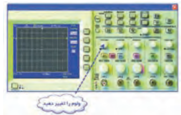
شکل ۲-۱۰۲ تغییر مکان عمودی خط GND
