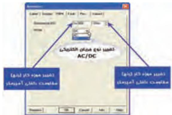
شکل ۲-۷۴ صفحه‌ی تنظیمات تعیین رنج آمپر‌متر
