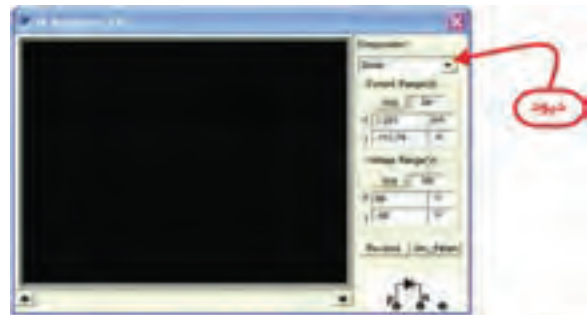
شکل ۲-۱۲۳ انتخاب قسمت دیود در دستگاه کروتریس
