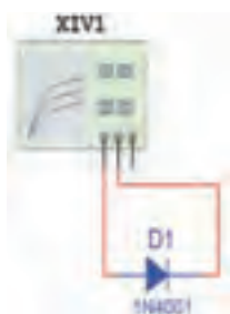
شکل ۲-۱۲۲ اتصال دیود به دستگاه کروتریسر
