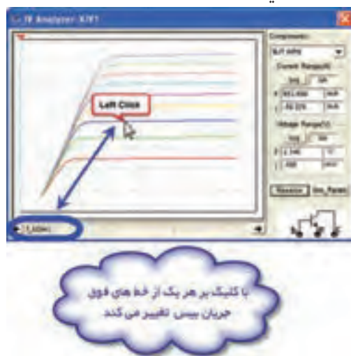
شکل ۱۳۳-۲ الف منحنی مشخصه‌ی ترانزیستور
