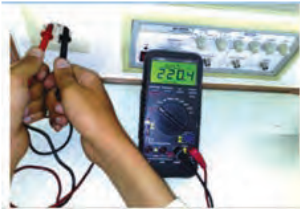
شکل ۲-۷۹ اندازه‌گیری ولتاژ برق شهر
