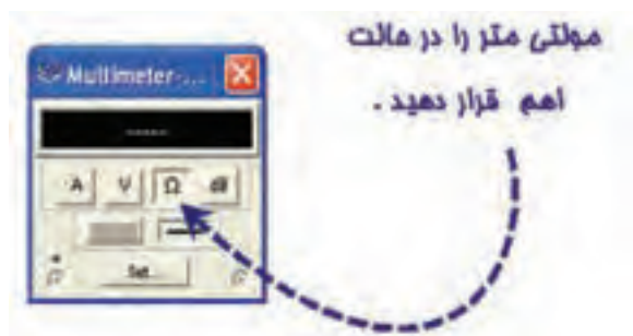
شکل ۲-۶۳ مولتی متر در حالت اهم متر
