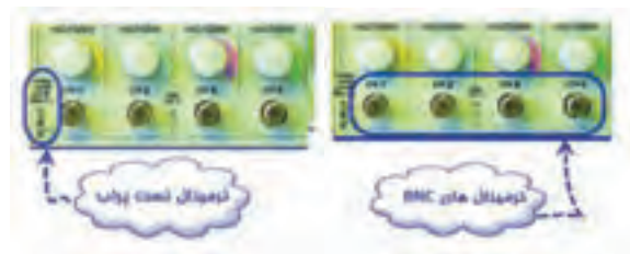
شکل ۲-۹۲ ترمینال تست پراب و کانال های ورودی دستگاه
