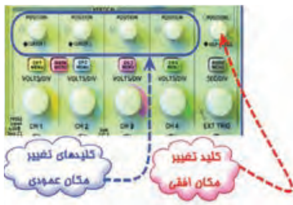
شکل ۲-۹۶ کلیدهای تغییر موقعیت عمودی و افقی
