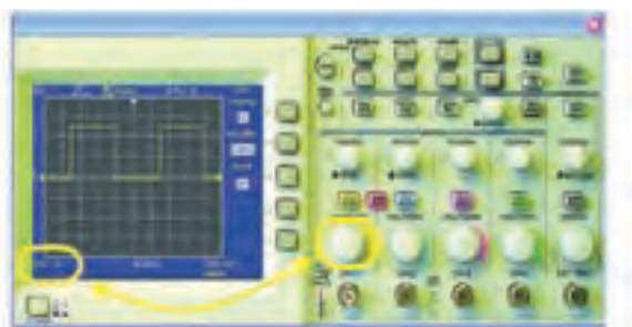
شکل ۲-۱۰۱ تغییر کلید نمایش عدد ضرب Volt/Div
