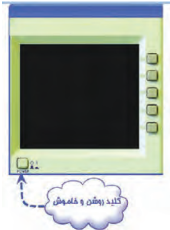
شکل ۲-۹۰ کلید روشن و خاموش دستگاه اسیلوسکوپ
