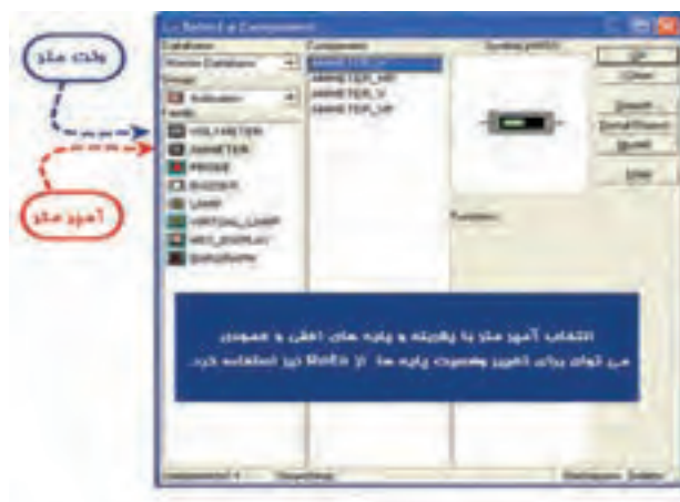
شکل ۲-۷۳ انتخاب آمپرتر و ولت‌متر از منوی نشان‌دهنده
