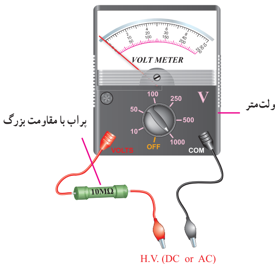
شکل ۲-۲۵ نمونه‌ای از پراب «ولتاژ زیاد» که با ولت متر، سری شده است.
