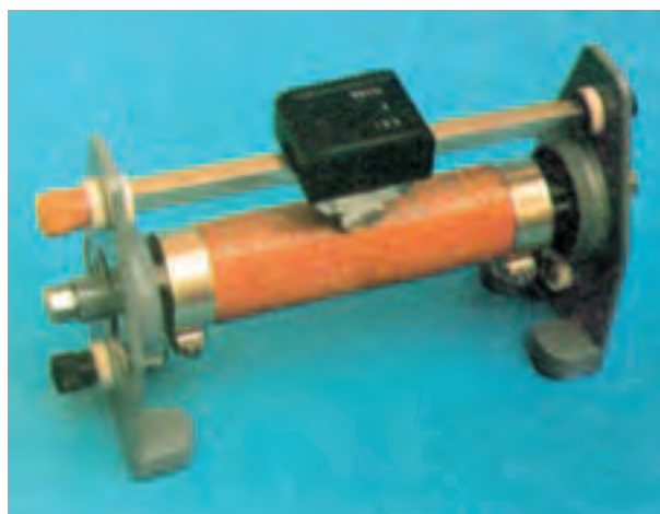
ب - مقاومت سیمی متغیر (رئوستا)
