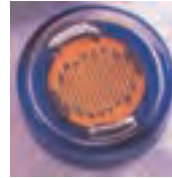
شکل ۱-۱۴- نمای ظاهری و علامت اختصاری یک فتورزیستور
