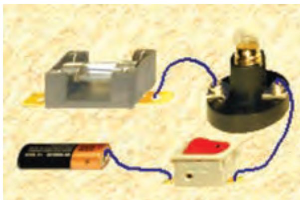
شکل ۱-۴۰ سیم متصل شده به باتری و کلید قطع شده و لامپ به حالت خاموش در آمده است.
