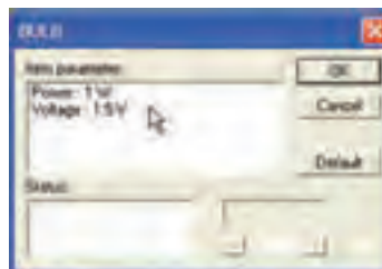
شکل ۱-۳۷ تغییر ولتاژ لامپ از ۵/۶V به ۱/۵V
