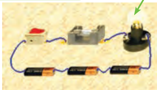
شکل ۱-۵۶ تعمیر لامپ سوخته
