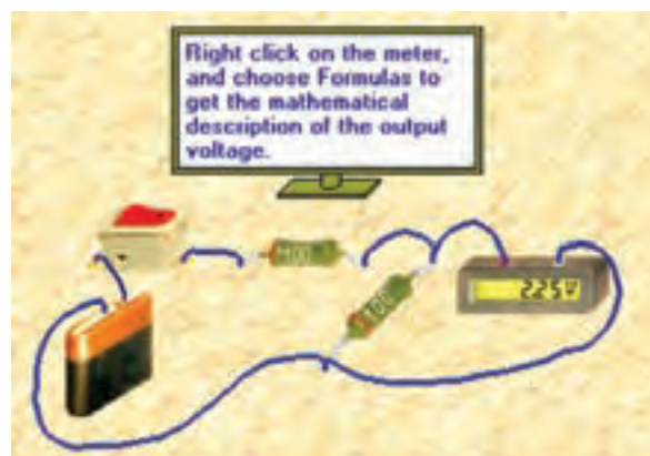
شکل ۱-۵۸ مدار تقسیم ولتاژ بین دو مقاومت
